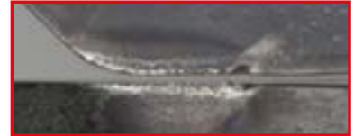
Isıya dayanıklı ve titanyum alaşımlarının işlenmesinde ufalanmaya karşı dirençli kesme kenarı
