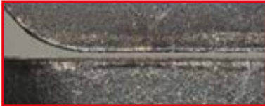
Çelik işleniyorken aşınmaya dayanıklı kesme kenarı
